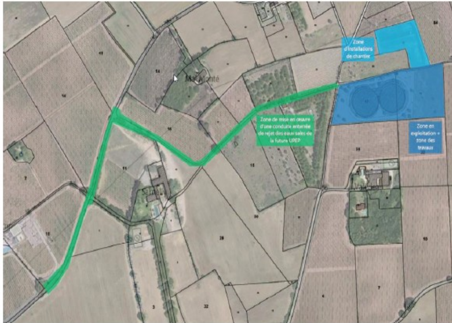
Figure 4 : Schéma de la future usine de Valédeau (En bleu : la zone en exploitation et la zone des travaux comprenant l'emprise du chantier, en vert : zone de mise en oeuvre d'une conduite enterrée)
